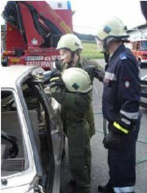
Nach den Bewerben wurde eine technische Übung abgehalten. Auf eine theoretische Einführung folgte dann die Umsetzung in die Praxis am Fahrzeug. Die Autoscheiben wurden mit einem Glasmaster entfernt, worauf die Jugendlichen unter Anleitung von Feuerwehrkameraden das Auto zerschneiden durften. Mithilfe von Schere und Spreizer wurden die Türen und das Dach entfernt.
