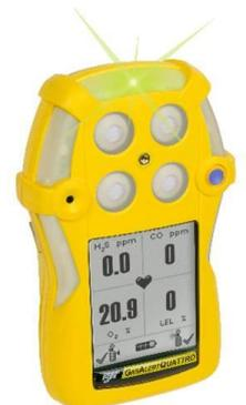
Den Messstützpunkten wurden dazu „GasAlert Quattro“ und zusätzlich das Mehrgasmessgerät „MultiRAE Lite“ zur Verfügung gestellt. Dieses Gerät ist zusätzlich mit einem Photoionisations-Sensor (PID), einem Schwefelwasserstoff-Sensor und einem Chlor-Sensor ausgestattet. Für die Oststeiermark ist die Feuerwehr Gniebing der Messstützpunkt.
